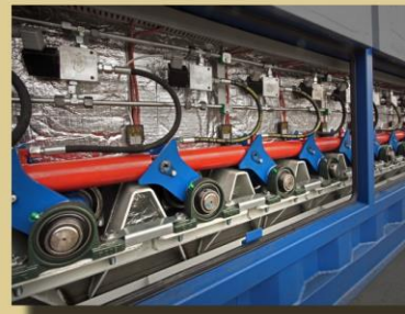
Cylindry hydrauliczne i dwukierunkowe dźwignie przechylające segmenty wahadłowe
