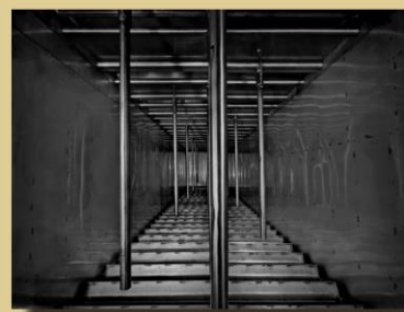
Nierdzewna przestrzeń robocza z prętami napowietrzającymi i temperatury oraz z 36 segmentami wahadłowymi
