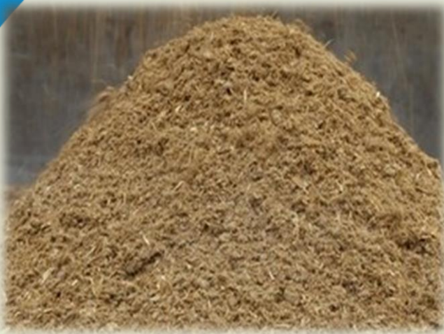
Odvodněný digestát z BPS
